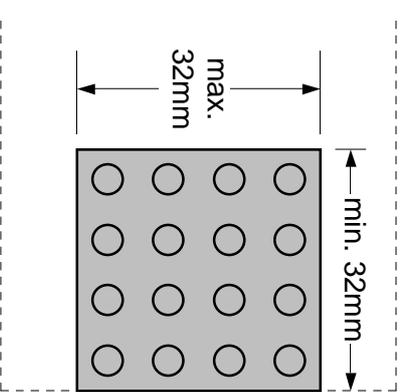
10mm über und unter der Abdeckplatte sowie links von ihr darf der Laserstrahl vom Fahrzeug nicht abgedeckt werden!
